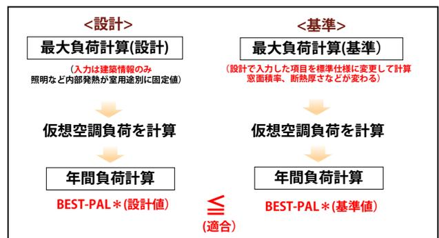
図-2 BEST-PAL\*における設計計算と基準計算の流れ
