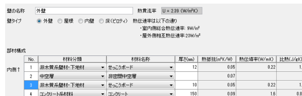
図8 外壁部材の入力
