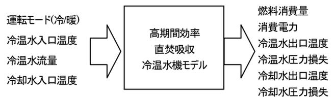
図 1. 高期間効率吸収冷温水機の入出力
