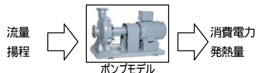
図7-1 ポンプモデルの入出力
