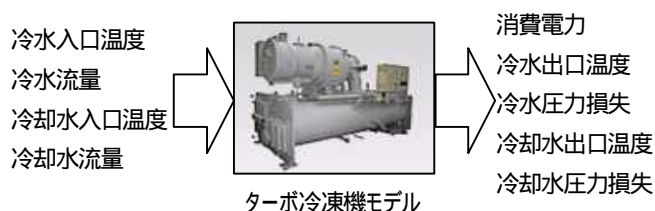
図3-1 ターボ冷凍機モデルの入出力
