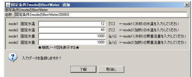
図3 固定条件モジュールの仕様入力ダイアログの例 ( ConstantWater2ModeModule )
