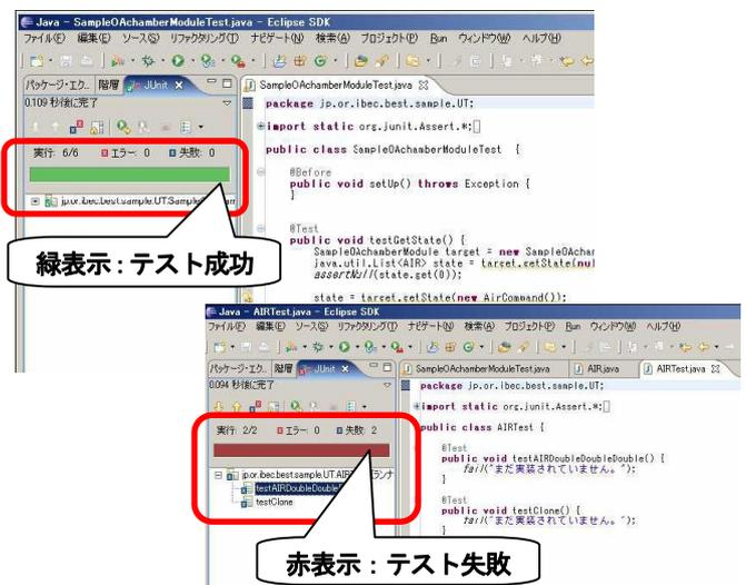
図3 JUnitによるテストの実行例
