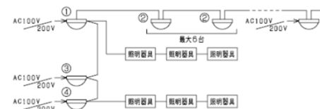
人感センサ (ローカル単独制御) による自動点滅制御
