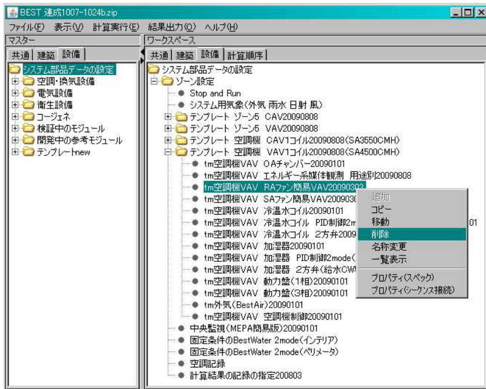
図 3.2.2-1 モジュールの削除
