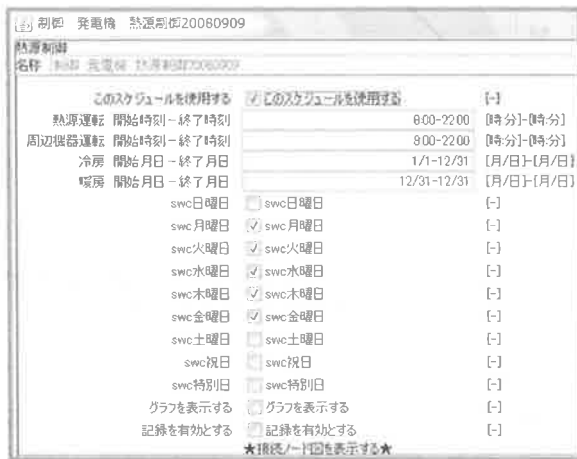
図6 BEST (O810版)におけるガスエンジンの入力画面 (数値は例)
