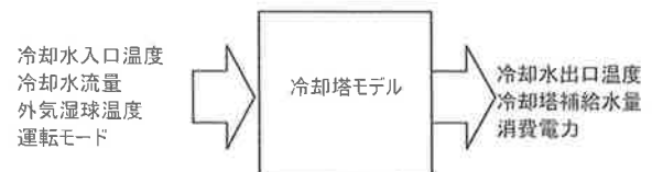
図5 冷却塔モデルの入出力
