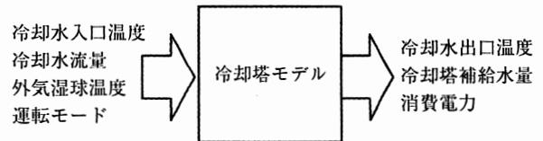
図-5 冷却塔モデルの入出力
